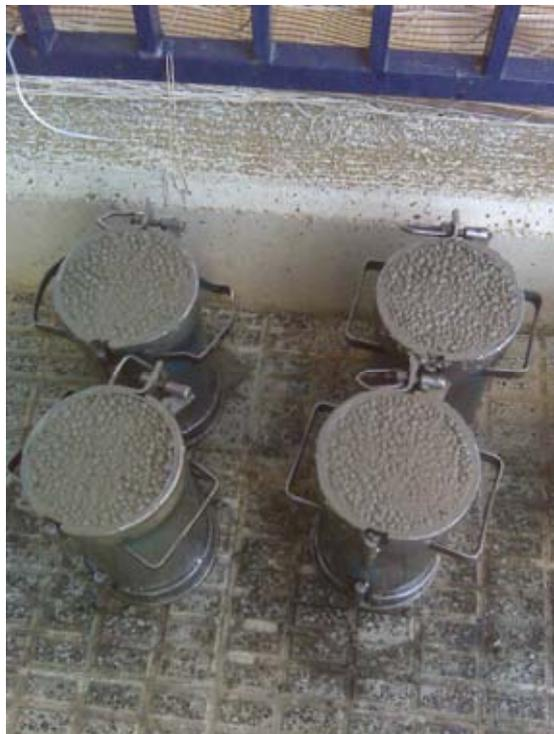
Probetas ejecutadas en obra
