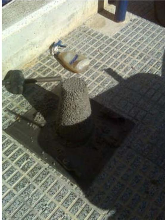
Ensayo de consistencia
